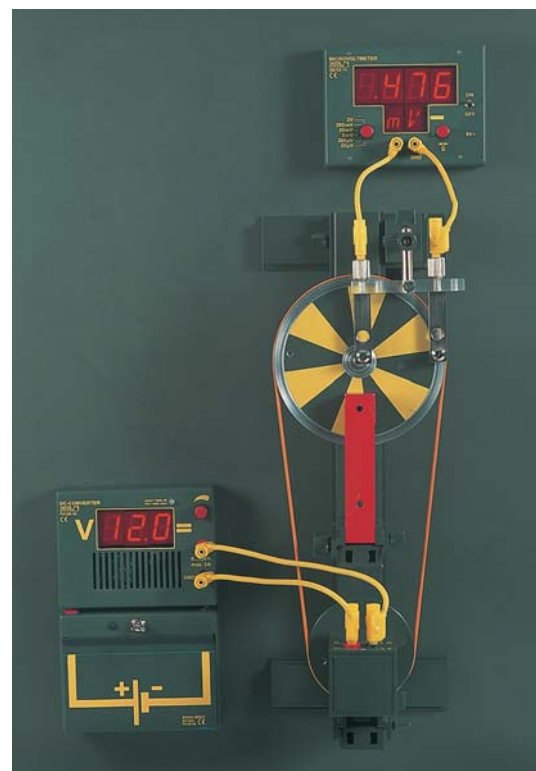
Test av Lorentz kraft i en roterande metallplatta i ett magnetfält
