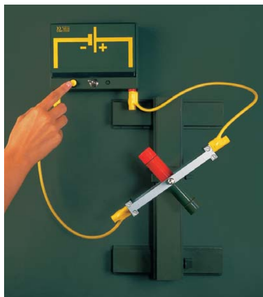
Orstedts försök (elektrisk ström skapar ett magnetfält)
