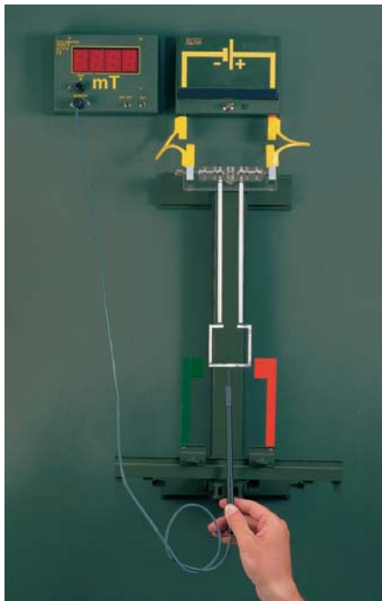
Kraften i en rak strömförande ledare parallellt med ett magnetiskt fält
