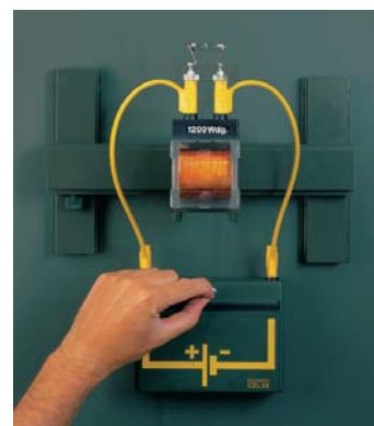
171 Avstängning genom självinduktion
