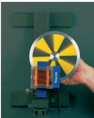
Skapa ett roterande fält - spaltpoleseffekt
