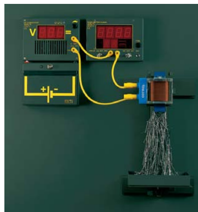
79 Magnetisk kraft i en strömförande spole
