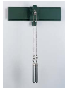
Effekten av magnetfältet på två hängande järnstänger
