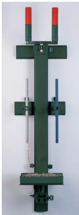
Magnetisk influens på järn och stål
