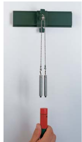
Effekten av magnetfältet på två hängande järnstänger
