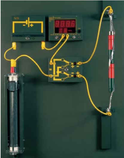
76 Dynamisk effekt av en flexibel strömförande ledare inom ett inhomogent magnetfält från en stavmagnet
