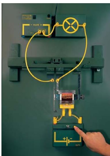
94 Modell av ett relä, normalt öppen brytare
