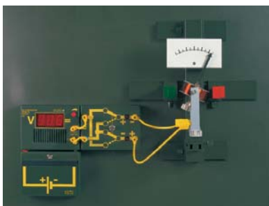
Strömförande spole i ett magnetfält - rörlig spole
