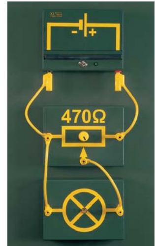
Reglering av ljus med potentiometer
