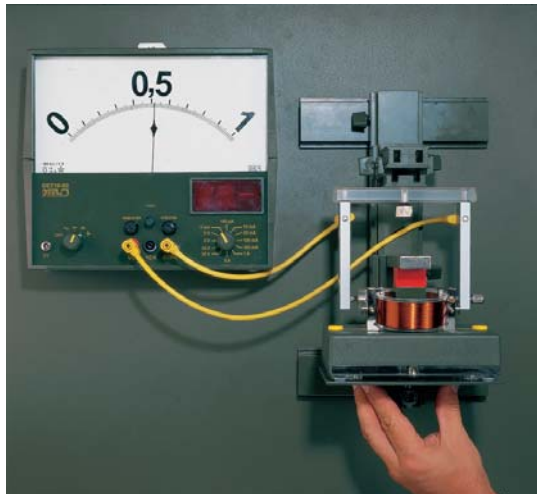
Hur en elektro-dynamisk mikrofon fungerar
