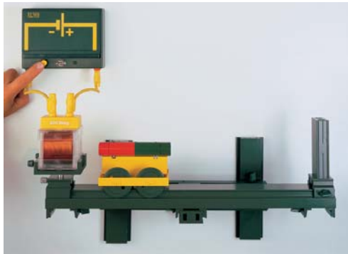
80 Effekten av magnetisk kraft i en strömförande spole
