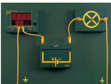
19 Sluten strömkrets genom jordning
