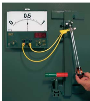
Växelvekan av en fast spole och en rörlig magnet likaväl som en fast magnet och en rörlig spole
