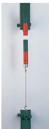
Den fast monterade magneten attraherar den kedjeupphängda magneten
