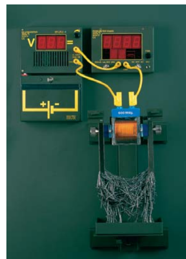
Bestämning av polerna i en strömförande spole med en permanentmagnet
