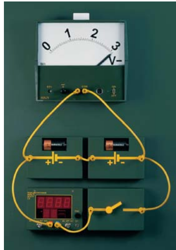
11 Spänningskälla i seriekoppling - kortslutning
