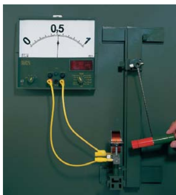
Växelvekan av en fast spole och en rörlig magnet likaväl som en fast magnet och en rörlig spole
