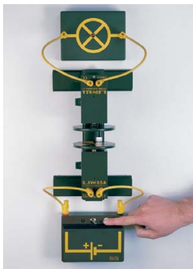
En motor driver en generator En generator driver en motor
