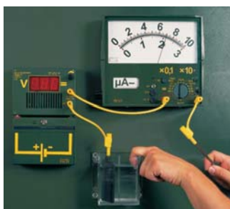
19 Sluten strömkrets genom jordning
