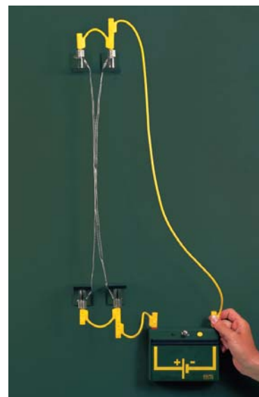
Krafter mellan parallella strömförande ledare
