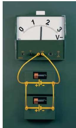
Spänningskälla vid parallellkoppling
