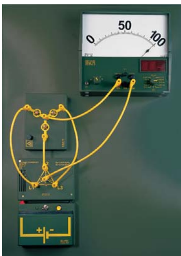
03 Stjärnkoppling - strömmätning i mittpunktsuttaget
