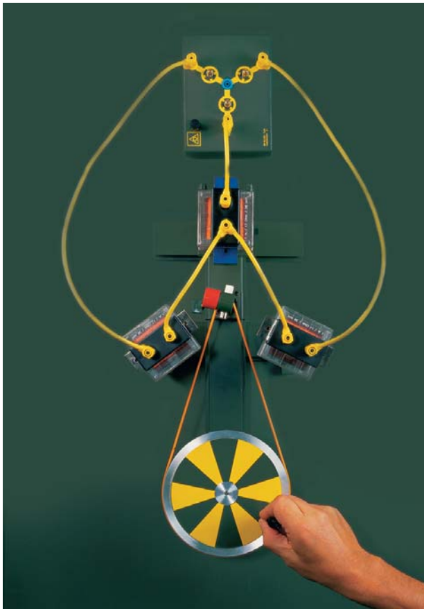
01 Tre-fas generator ger tre-fas ström
