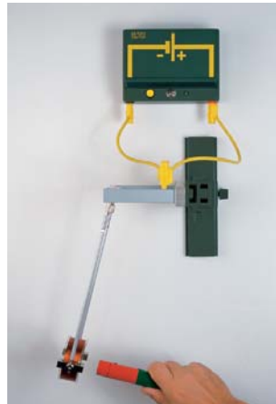
81 Växelverkan mellan en permanentmagnet och elektromagnet
