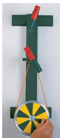
Den fast monterade magneten attraherar den kedjeupphängda magneten
